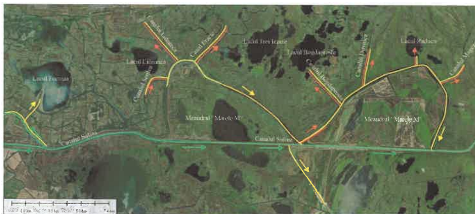
Fig. 9 - Conectivitatea hidrologică în zona studiată, cu galben meandrele rectificate și canalele laterale deconectate în mod ocazional de canalul Sulina, doar în cazul nivelurilor de apă mici și cu roșu arealele care pierd complet conectivitatea la ape mici
