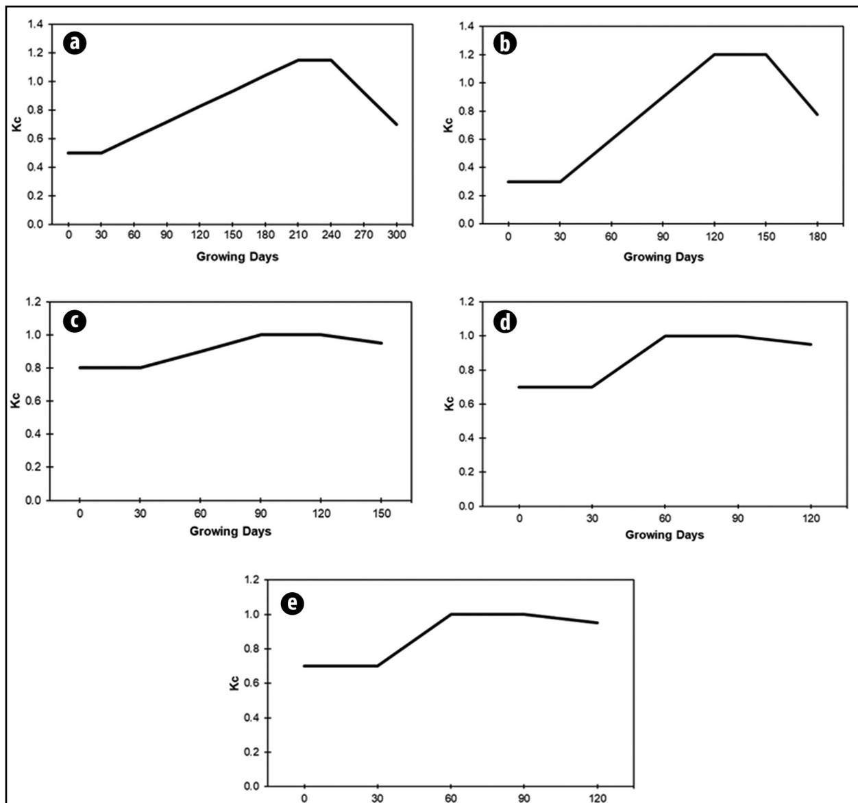
**Fig. 7.** Crop Coefficient ( $K_c$ ) values for (a) Wheat, (b) Maize, (c) Water Melon, (d) Tomatoes & Cucumber, and (e) Pepper.
