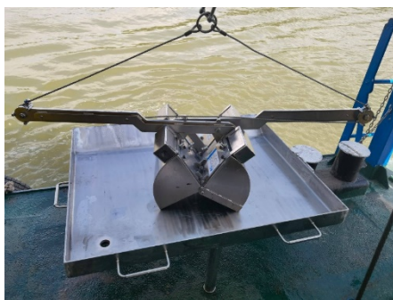
Fig. 4. Bodengreifer Van Veen utilizat pentru prelevarea probelor de sedimente
