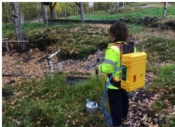
Măsurători de flux executate cu fluxmetru portabil West Systems
