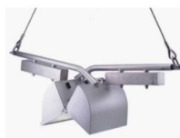
Prelevator sedimente - Bodengreifer Van Veen 1000 cm 2
