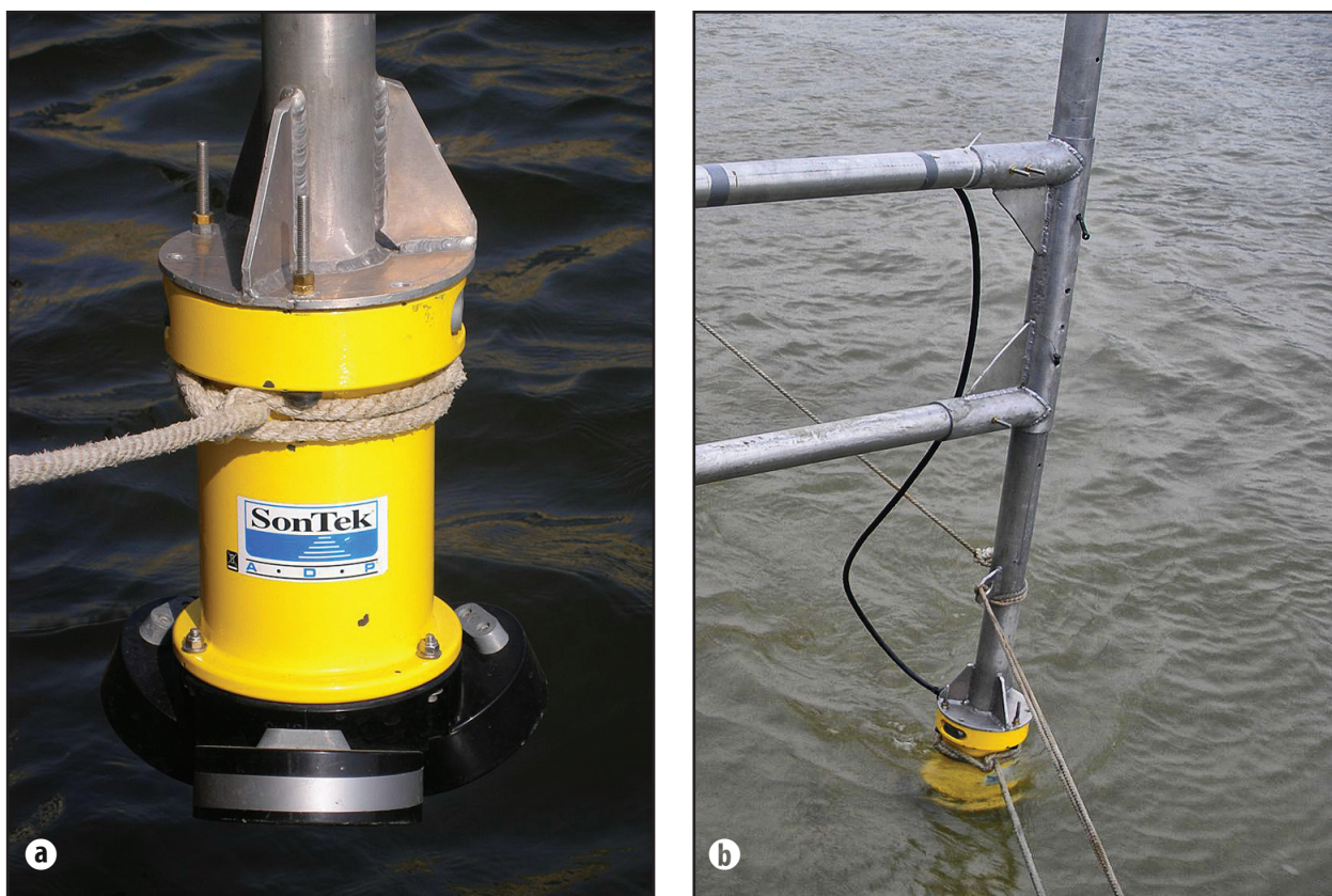
Fig. 1 Sistem de măsurare a vitezelor de curenți și a debitelor Sontek ADP – RiverSurveyor
