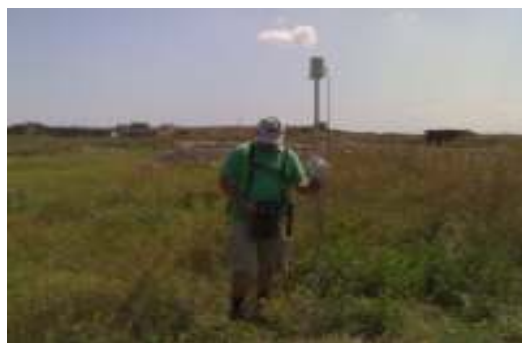
Fig. 3 Măsurători magnetometrice / gradientmetrice în zona necropolei Histria
