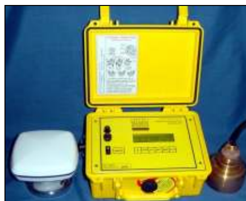
Fig. 3. Sistemul batimetric Ceeducer cu ajutorul căror au fost efectuate ridicările batimetrice
